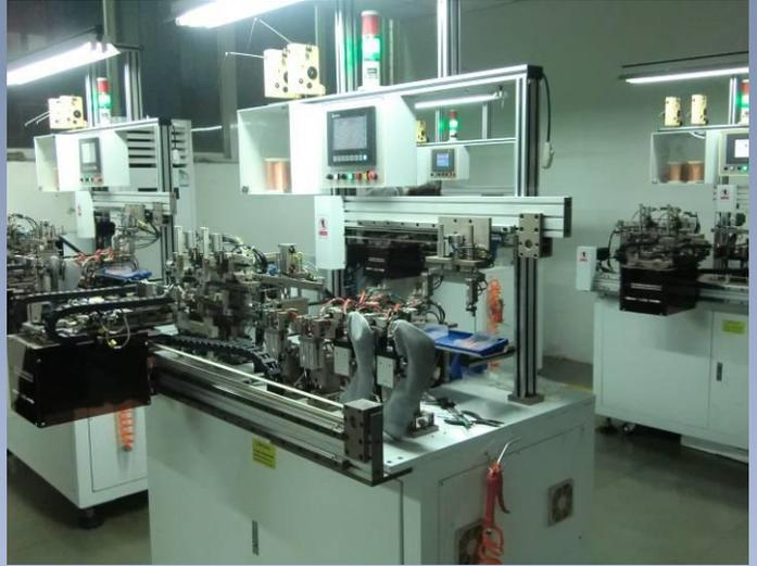
Máquina de bobinado automático
